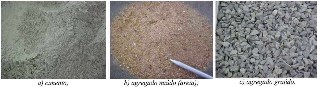
Figura 2.1 – Materiais básicos constituintes do concreto.
